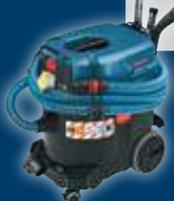
1.380 W. 35 L. Filtro de poliéster (clase M). Para seco y húmedo. Conexión sincronizada con herramientas hasta 2.200 W. Equipo y tuberías anti-estático. Limpieza de filtro automática. 254 mbar. Se puede clicar un L-BOXX con herramientas encima. 12,4 Kg.
